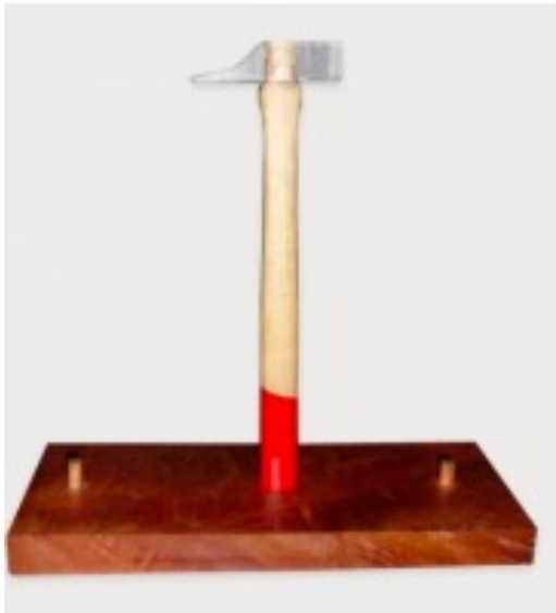
A4 — Marteau à tête de carre. La fragilité de sa tête en fait l'outil idéal pour les travaux délicats.
