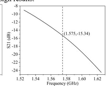
Fig. 8.  $S_{21}$  parameter of the antenna.
