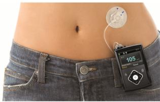
Figura 1: Sistema de Monitorización Continua de Glucosa
